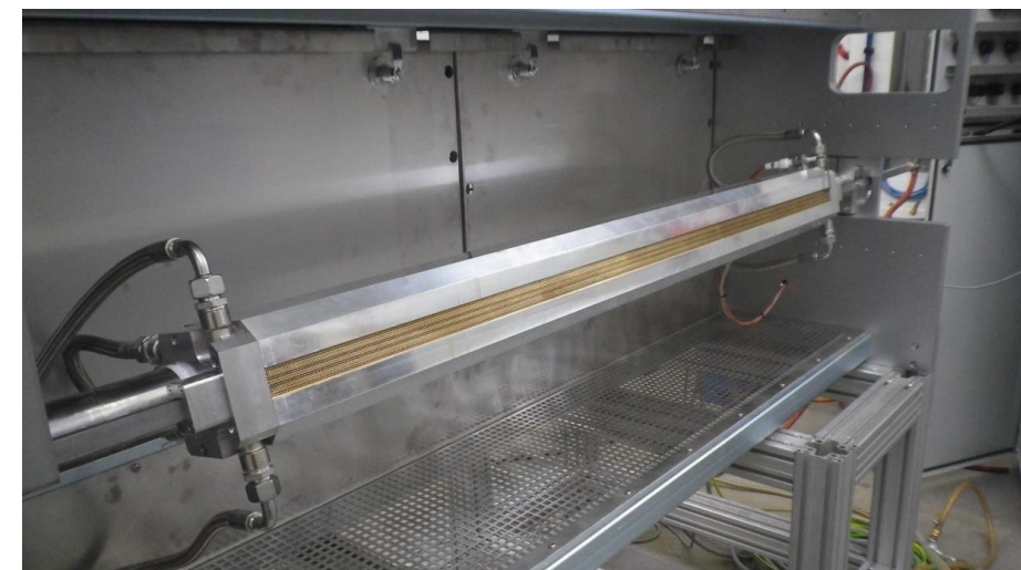
Stanice pro předúpravu plamenem pro integraci do linky pro extruzní potahování
