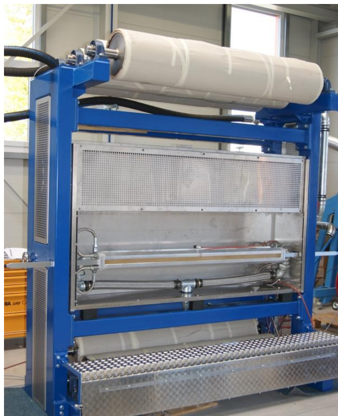
Předúpravná stanice s válečkovým rámem pro integraci do stávajícího procesu nanášení lepidla
