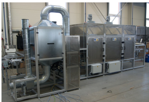
Oboustranná předúprava automobilových kufřů uspořádání více hořáků, samostatně volitelné
