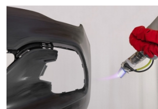
Předúprava plamenem nárazníků před nanesením laku Hořák S226-250SS
